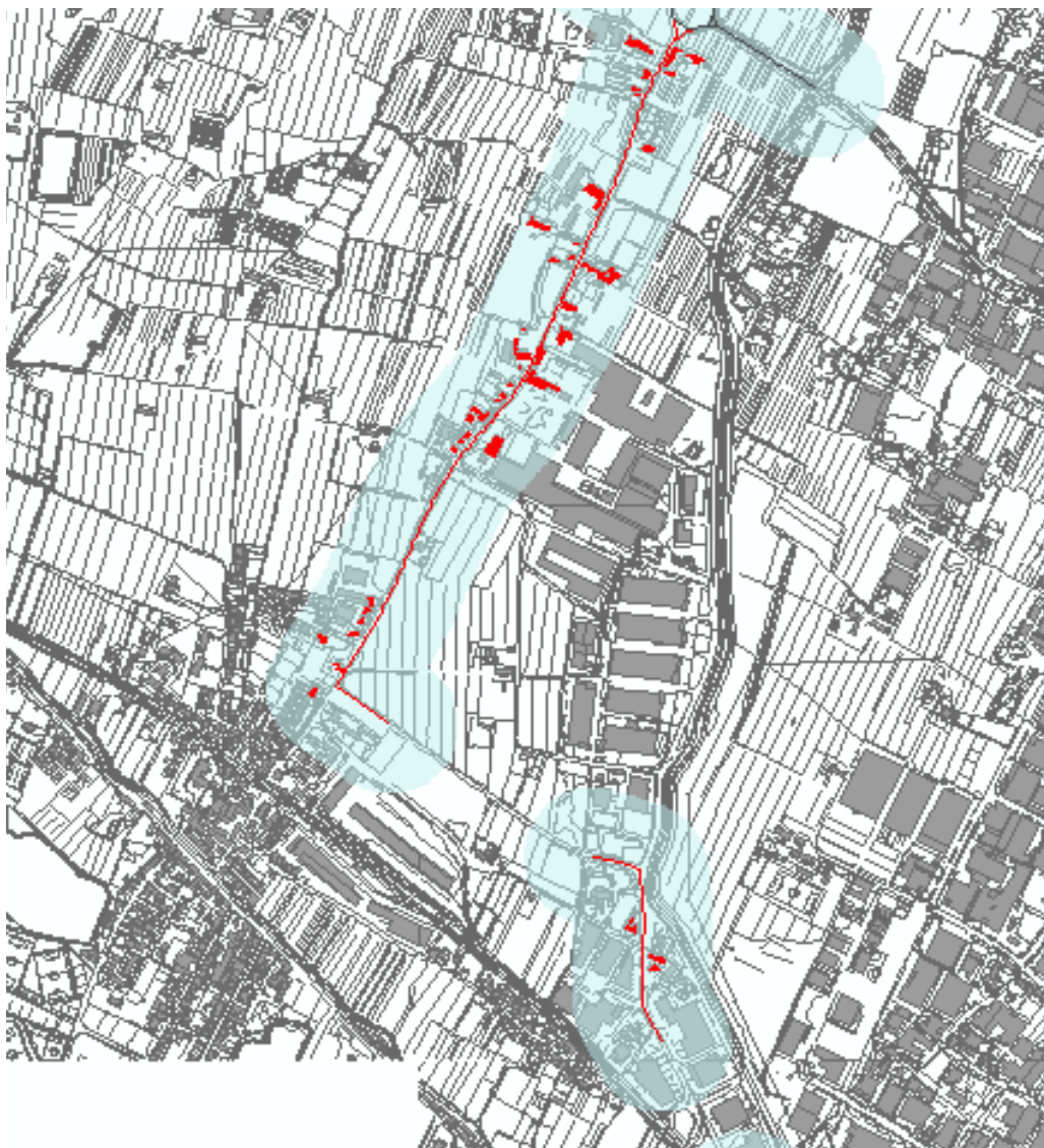
Figura 4.3.1 SP 07 Suddivisione in due zone omogenee oggetto di risanamento acustico (in rosso edifici critici)
